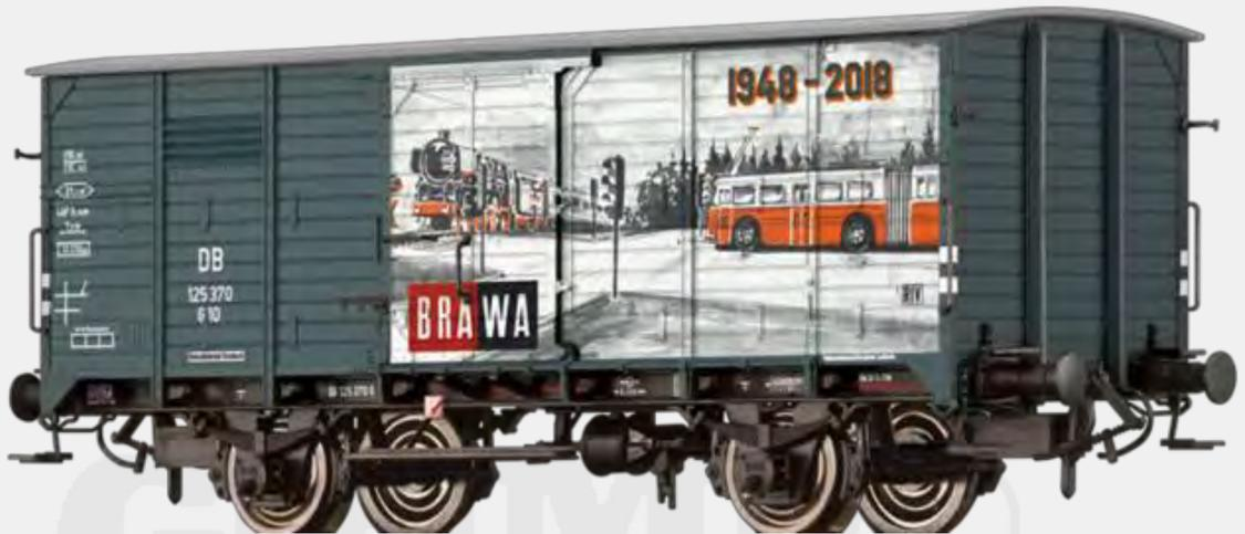
Tarifliche Bedingungen und technische Gegebenheiten führten dazu, dass alle Länderbahnverwaltungen gedeckte Güterwagen mit fast gleichen Abmessungen und Ladegewichten entwickelten. Es handelte sich um Wagen mit 4,5 m Radstand, einer Länge über Puffer von 9,3 m bei ungebremsten Wagen, einem Ladegewicht von 15 t (später 17,5 t) und einer Bodenfläche von etwa 21 Quadratmeter.
