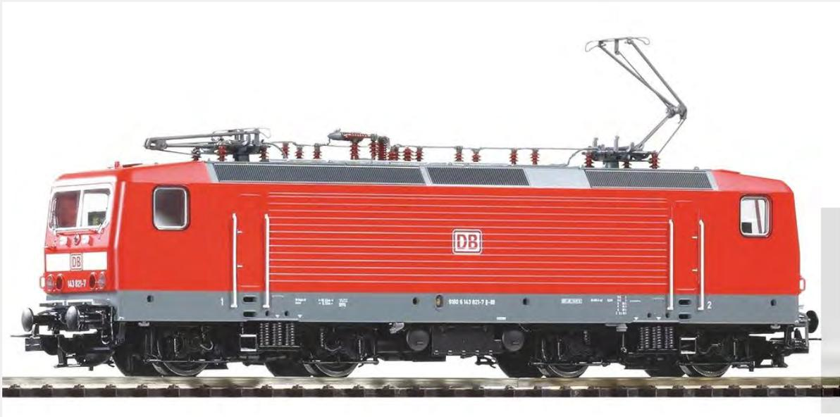
**Elektrolokomotive Baureihe 143 der Deutschen Bahn AG (DB AG), Epoche VI.**
