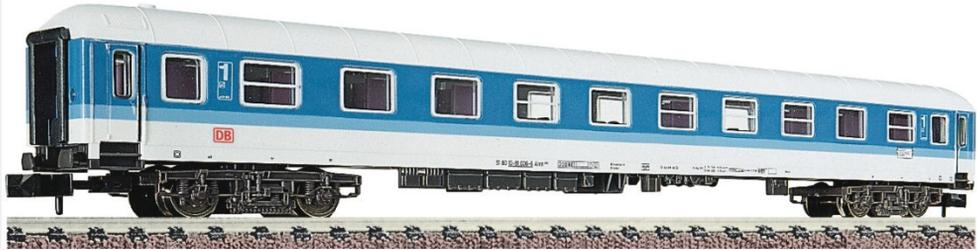
InterRegio-Wagen 1. Klasse, Bauart Aimh260, der Deutschen Bahn AG, Epoche V.
